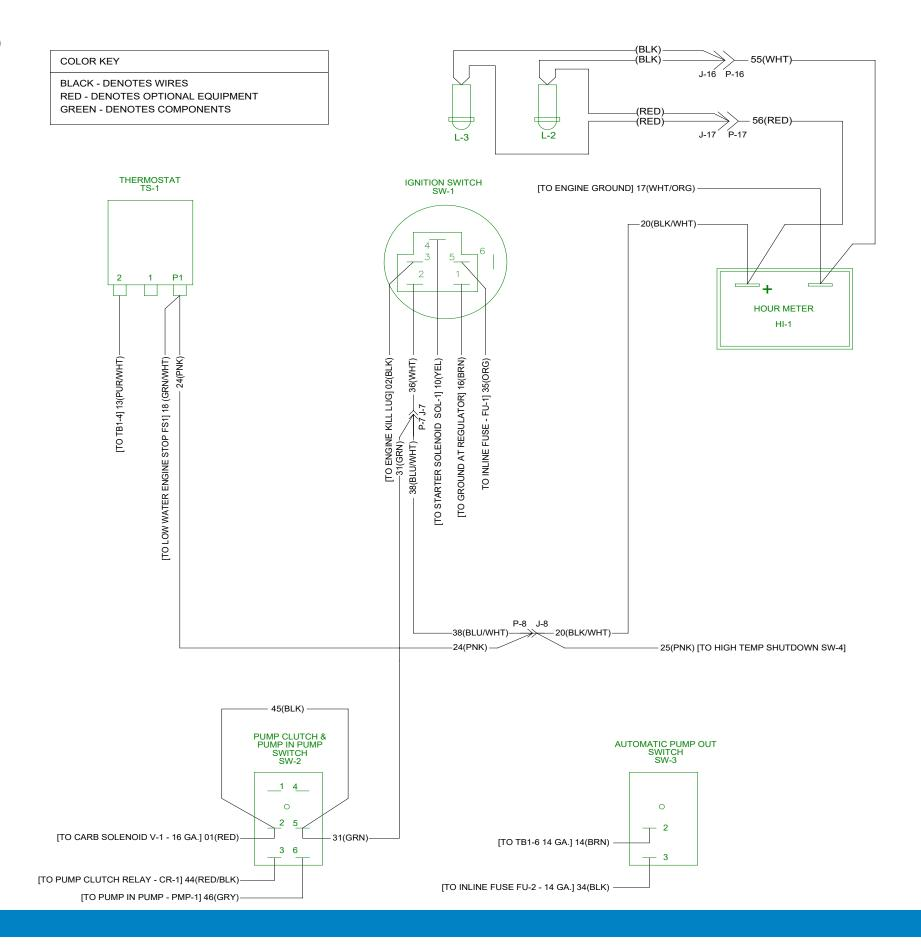
Figure 6-3. Wiring
